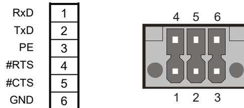
Der verwendeten Combicon-Steckverbinder ist vom Typ DMC 1,5/3-G1F-3,5 (Phoenix Contact), ein geeigneter Gegenstecker ist beispielsweise der Typ DFMC 1,5/3-STF-3,5.
