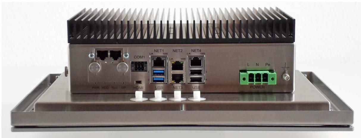
Sämtliche externen Stecker werden an der Unterseite des Elektronikrahmens angeschlossen. Dadurch kann das System auch in sehr schmale Schaltschränke oder in Baugruppenträger eingebaut werden.
