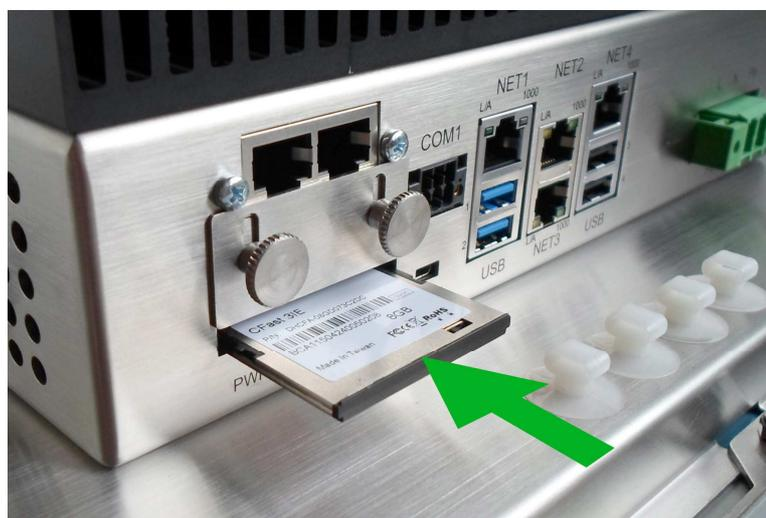
**Achtung:** Die CFast-Karte darf nur auf die hier beschriebene Art ohne nennenswerten Kraftaufwand eingesteckt werden! Ein gewaltsames, verdrehtes oder verkantetes Einsetzen beschädigt den CFast-Sockel!
