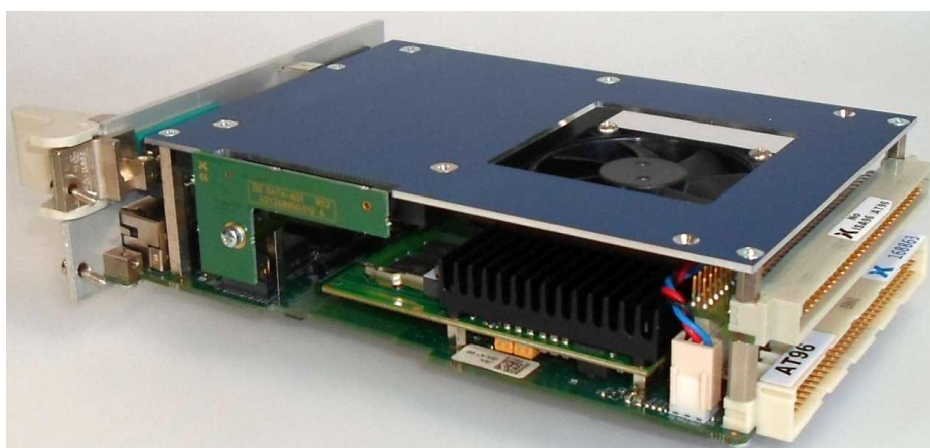
H1/103 Version mit Rear-Extender und Alu-Trägerplatte mit 2,5“-SATA-SSD. Erkennbar ist der fest montierte vertikale Adapter für 2,5“-Laufwerke „D2 SATA AD1“.
